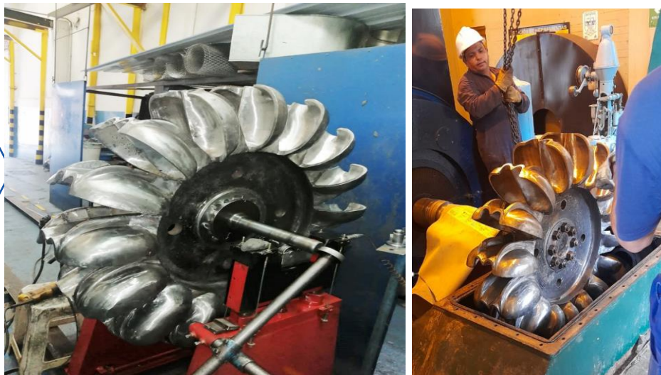
Grafica No. 24: Puesta en Operación Turbina Pelton, PCH Asnazú
